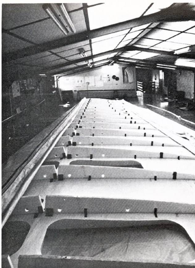
Photo 4 La grand-voile de Gautier III (Meccarillos) en construction : 100 m 2 . Les nervures articulées sont nettement visibles.
